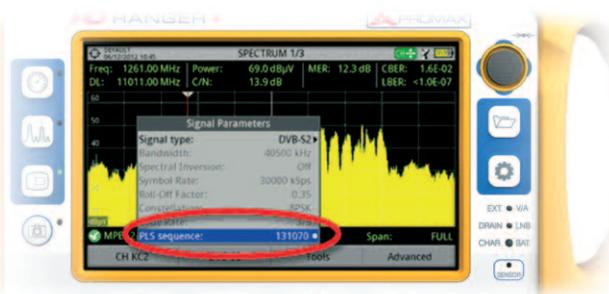
Der **HD RANGER+** kann diese Signale verarbeiten. Der Benutzer muss lediglich die PLS Sequenznummer des Transponders eingeben, dann stehen Messfunktionen, Video-Demodulation und Prüfung der digitalen Empfangsqualität zur Verfügung.
