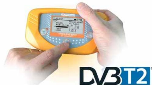
**1 Ausrichten** Das Gerät stellt die Informationen über die empfangene Signalleistung (Breitband analog und digital) in Form von zwei Messbalken mit verschiedenen Zeitkonstanten und einer akustischen Anzeige dar.
